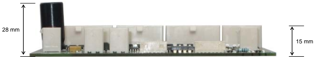
Abbildung 3: Abmessungen der FIOA-Platine, Seitenansicht.
