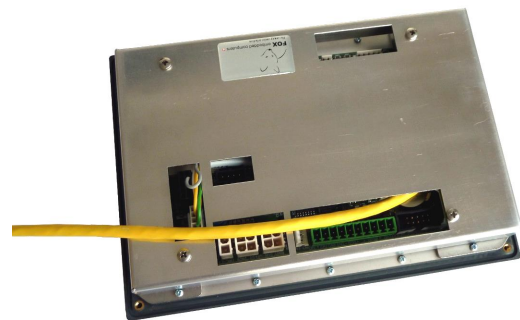
Abbildung 5: FES1_V1048 im eigerPanel70 eingebaut
